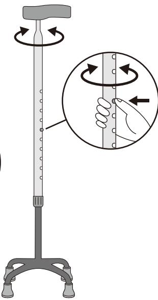
③長さを合わせて調節プロテクターをしっかりと締めます。
