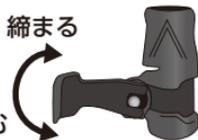
シャフトが縮んでしまう場合は、レバーを完全に開けた状態で時計回りに回転させて調節します。
