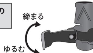
シャフトが縮んでしまう場合は、レバーを完全に開けた状態で時計回りに360° 1回転させて調節します。
